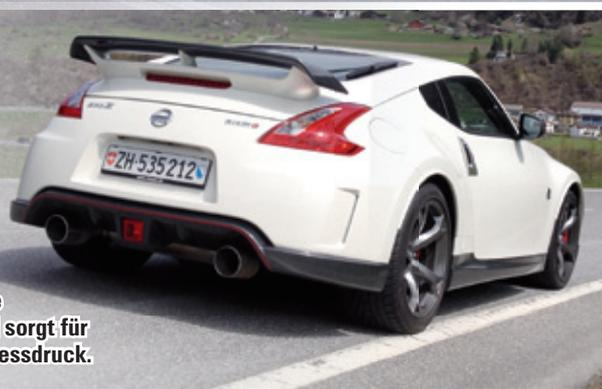
**Der grosse Heckflügel sorgt für mehr Anpressdruck.**
