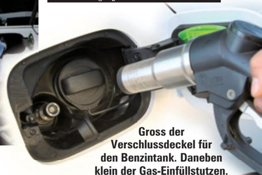
Gross der Verschlussdeckel für den Benzintank. Daneben klein der Gas-Einflusstutzen.
